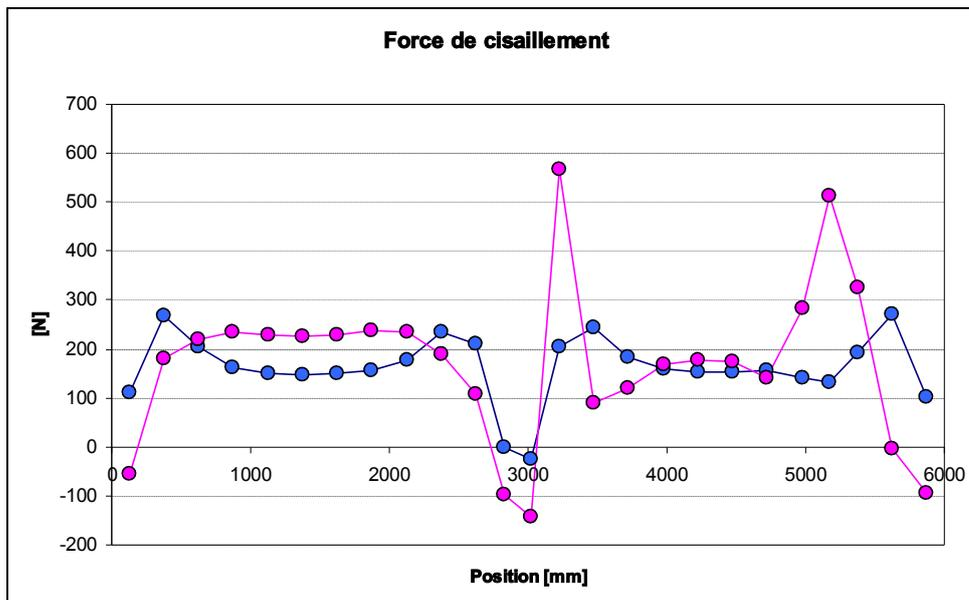
La force maximale de 400 N en tension est combinée avec une force de cisaillement de 600 N.
